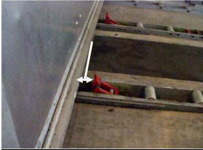
شكل رقم (٢) الخلوص بعد وضع عدد من وحدات التحميل
